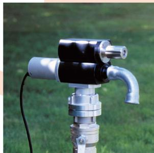
per localizzare condotte principali si mette in movimento la colonna d'acqua presente nella condotta, frenandola poi ad intervalli regolari con la valvola d'intercettazione "stopper"
