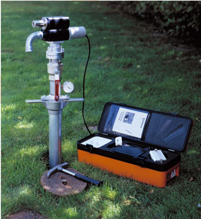
Le condotte in materiale plastico non sono localizzabili con il tradizionale metodo elettromagnetico, in quanto non conduttive elettricamente. E' stato pertanto realizzato un diverso sistema di localizzazione, basato sul metodo acustico.
